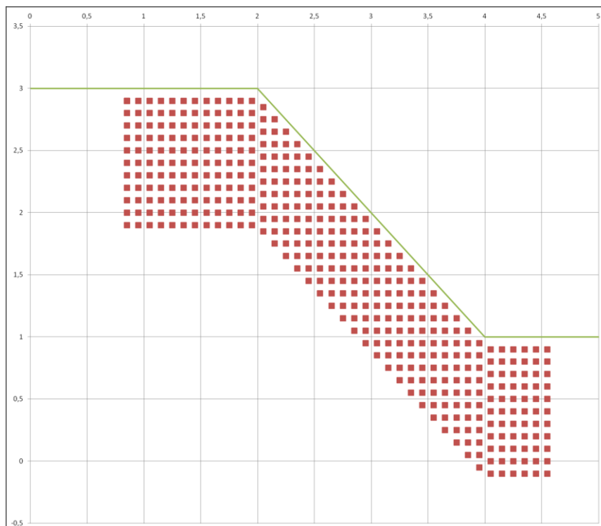
Рис. 12.6. Расположение начальных точек для построения поверхностей разрушения внутри расчетной схемы
