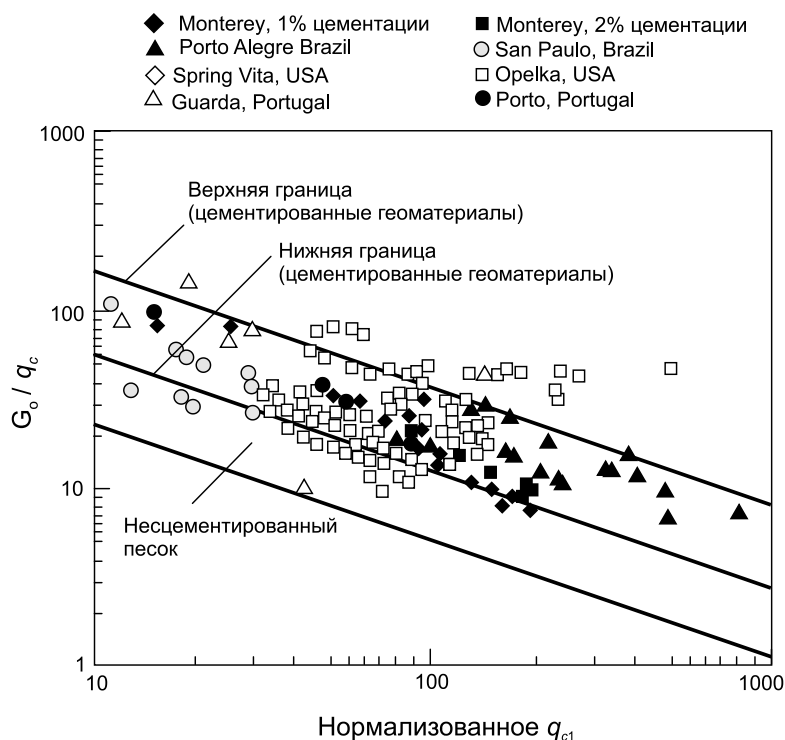
Рис. 4.21. Зависимость между G_0 и q_c для осадочных грунтов (Scnaid et al., 2004)
